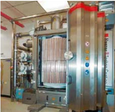
Fig. 3 Instalação sputter
