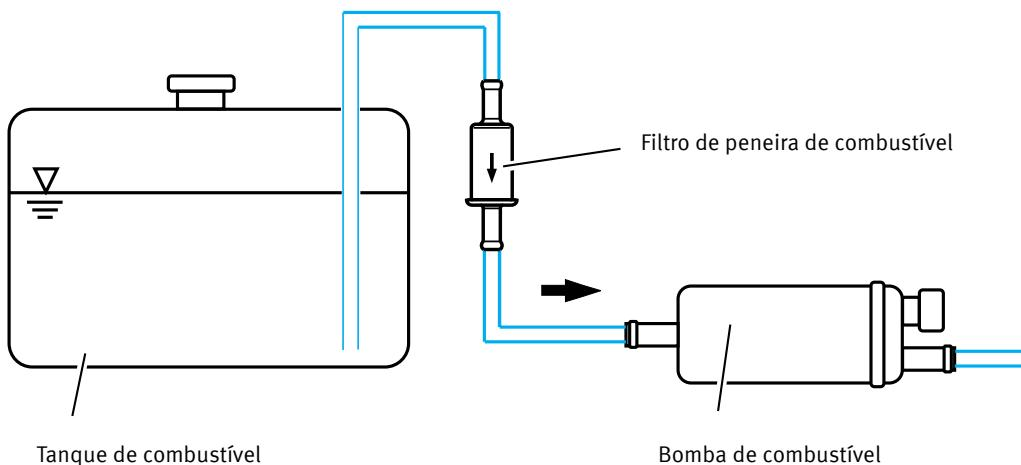
Os filtros de peneira podem ser instalados na linha de combustível entre o tanque de combustível e a bomba de combustível do tipo E1F (com diâmetro de 8 mm no bocal de sucção).
