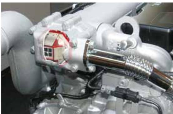
Обратный клапан на двигателе (оптически в разрезе)
