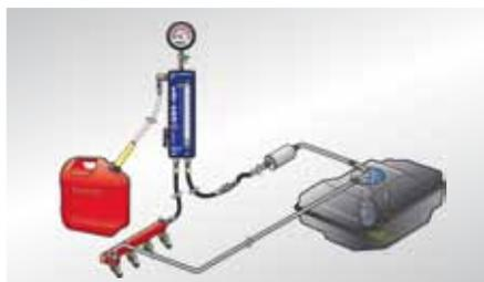
Exemple : dispositif de mesure dans le système d'alimentation en carburant avec retour
