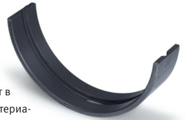
Новые подшипники скольжения снабжены дополнительным полимерным антифрикционным слоем, благодаря чему подшипниковый металл и полимерный слой могут выполнять различные функции. Поскольку гибкость, износостойкость и вместе с тем способность выдерживать нагрузку — это абсолютно противоречивые требования.
