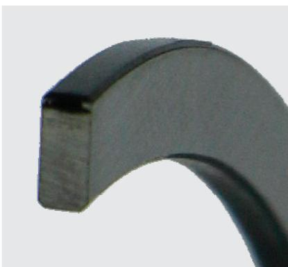
Fig. 1 : Revêtement DLC sur la surface de glissement
