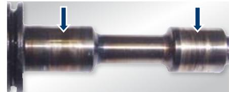
Abb. 3 Durch Ölsmangel beschädigte Turboladerwelle
