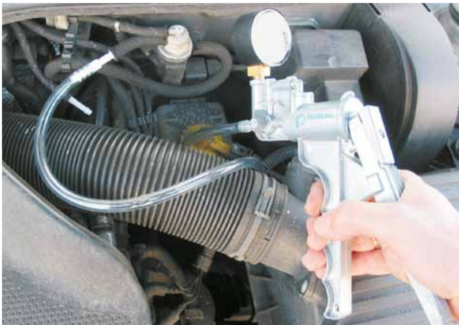
Verificarea unui convertor electropneumatic (EPW) cu pompa de vid manuală (VW Golf IV)
