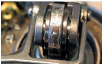
Manifestación de la avería: Rodillo de deslizamiento con muescas ('pittings') causadas por un disco de leva desgastado
