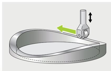
Accionamiento de la bomba de vacío por un disco de leva (en esquema)
