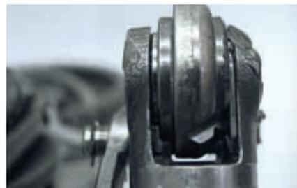
Manifestación de la avería: rodillo de deslizamiento desgastado de un lado
