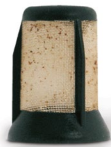
E3T'nin ön filtresi – pas nedeniyle tıkanmış
