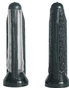
Préfiltre de la E1F : neuf à gauche, obstrué à droite
