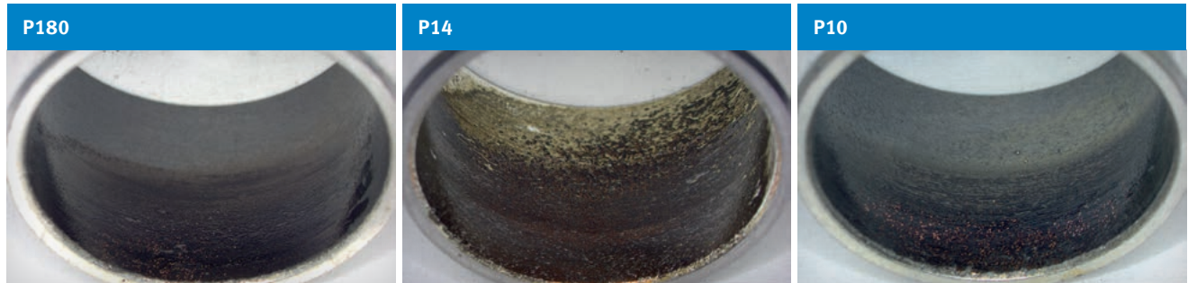
Kenar yüküyle kuru çalışmada rotasyon testinden sonra P180, P14 ve P10 kaygan tabakalarda aşınma
