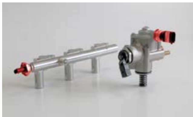
Αισθητήρες πίεσης καυσίμου (επισημαίνονται) στον σωλήνα πολλαπλής καυσίμου και στην αντλία υψηλής πίεσης
