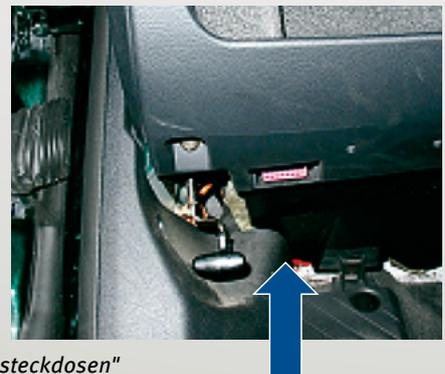
Abb. 9: Beispiele für Einbauorte von Diagnosesteckdosen"
