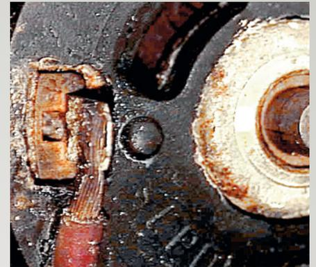
Abb. 29: Sekundärluftpumpe – Korrodierte elektrische Anschlüsse
