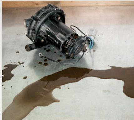
Abb. 28: Kondensat in der Sekundärluftpumpe
