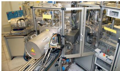
El procedimiento PVD: Revestimiento por magnetrón.
