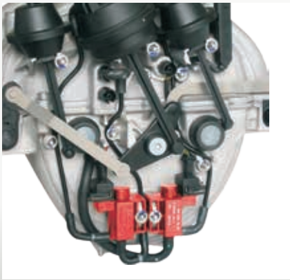
Электрический переключающий клапан (EUV) (выделено) на впускной трубе Mercedes-Benz класса
