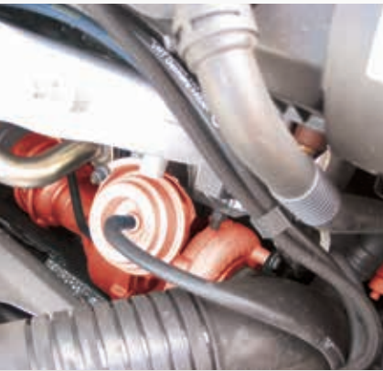
Электропневматический преобразователь давления (EPW) и турбонагнетатель на Audi A4 TDI (выделено)
