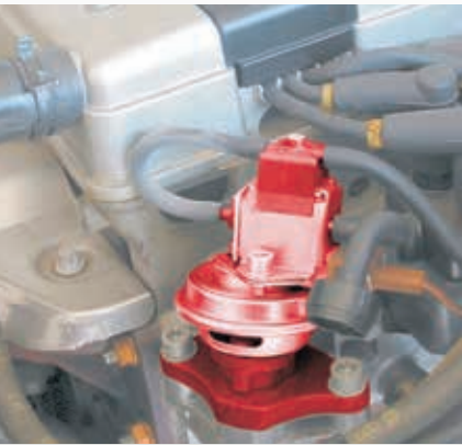
Электрический преобразователь давления (EDW) на AGR-клапане (клапане рециркуляции отработавших газов) на Opel Astra (выделено).
