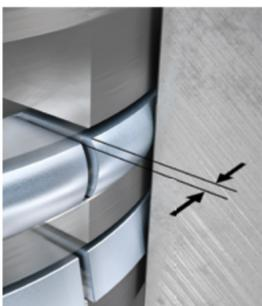
Das Kolbenringstoßspiel ist vergleichbar mit dem Ventilspiel. Bei der Erwärmung der Teile kommt es zu einer Wärmedehnung der Bauteile und zu einer Längenänderung. Das Stoßspiel bei kalter Maschine gewährleistet, dass es bei heißer Maschine nicht zum Klemmen der Kolbenringe im Zylinder kommt. Ist das Stoßspiel bei kalter Maschine zu klein, kommt es bei heißem Motor zu hohem Kolbenringverschleiß, zu Dichtproblemen und zu Motorschäden.
