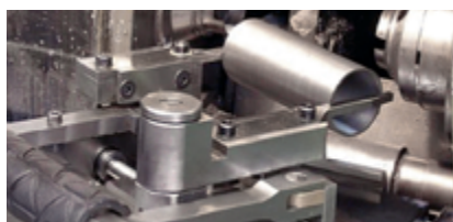
Szlifowanie powierzchni bieżnej pierścienia tłokowego
