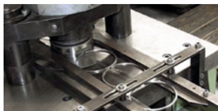
Automatyczna wytaczarka – wytwarzanie konturu wewnętrznego
