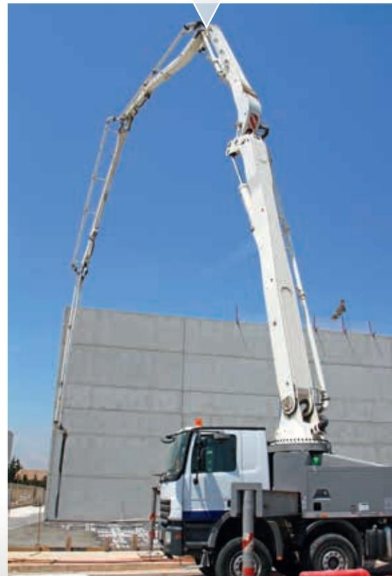
Mât distributeur en béton
