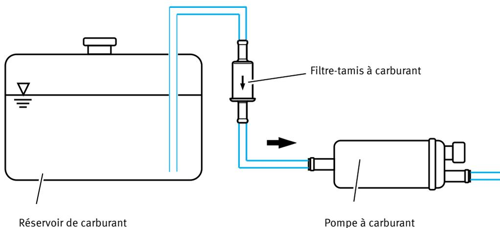
Les filtres-tamis peuvent être installés dans la conduite de carburant entre le réservoir de carburant et la pompe à carburant E1F (avec un diamètre de 8 mm sur la tubulure d'aspiration).
