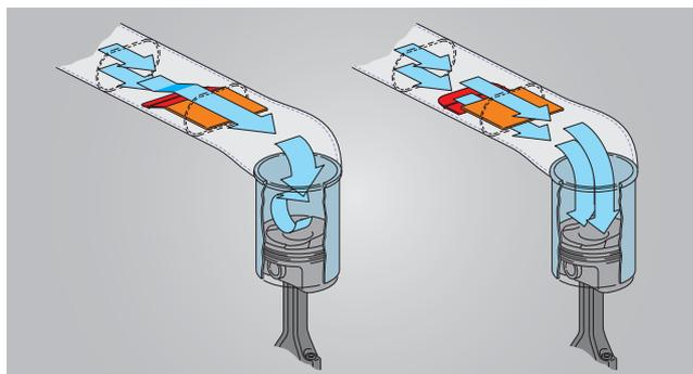
Fig. 3: Válvula de turbulencias: turbulencias perpendiculares a la dirección axial del pistón
