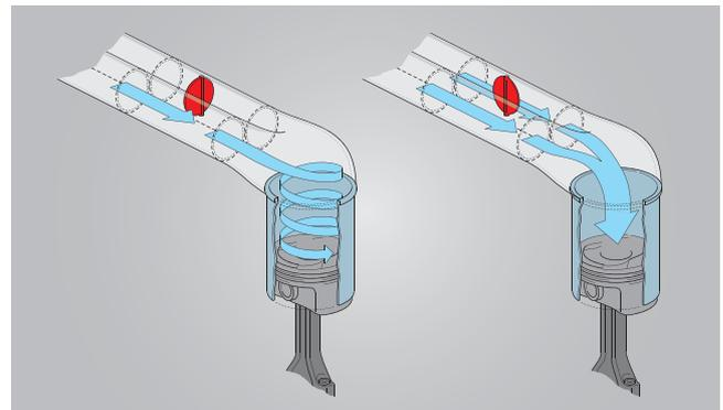
Fig. 1: compuerta de entrada de aire en espiral: turbulencia en la dirección axial del pistón
