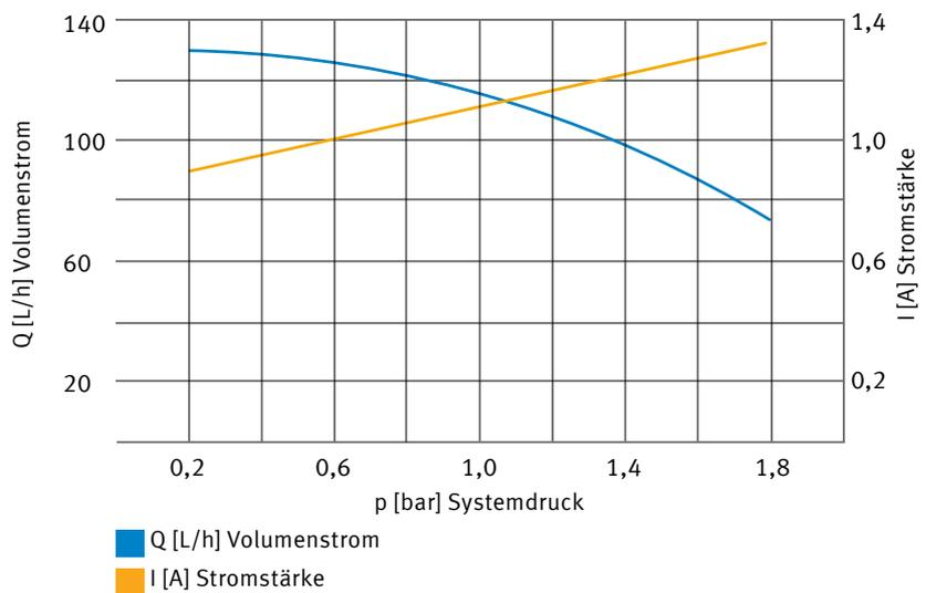
Abb. 2: Kennlinien für Stromstärke und Volumenstrom in Relation zum Systemdruck (Werte können abweichen)
