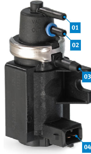
Şek. 2: Basınç konvertöründeki bağlantılar
