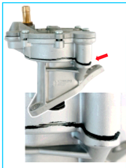
Sl. 1 Polomljeno kućište pumpe
