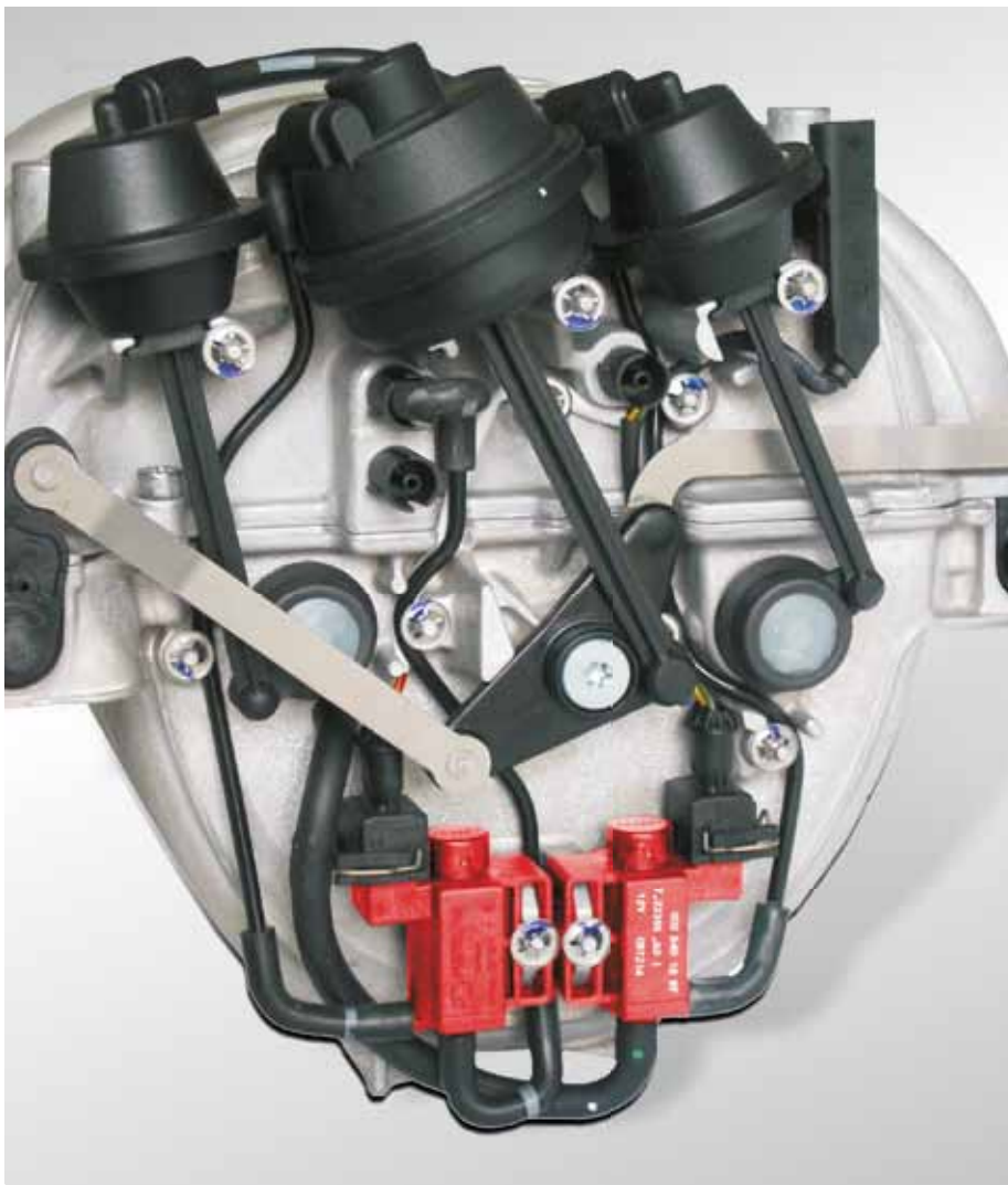
Alkalmazási példák Szívócső elektropneumatikus szelepekkel (pirosra színezve) a Mercedes C osztályban
