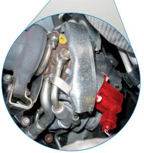
Клапан, дозирующий дополнительный воздух во впускной газопровод в режиме принудительного холостого хода в VW EOS TFSI (выделено красным)
