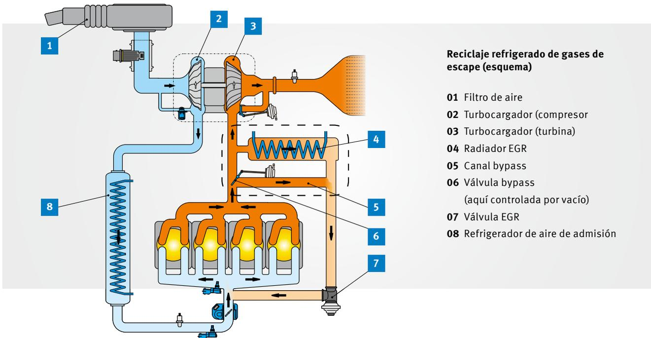
**Reciclaje refrigerado de gases de escape (esquema)**
