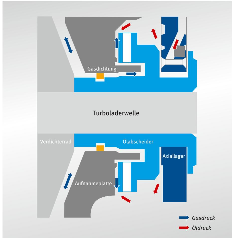
Abb. 1: Die Turbinenwelle „schwimmt“ auf einem Ölfilm
