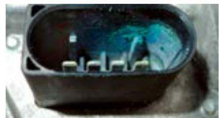
Connettore di montaggio con tracce di corrosione
