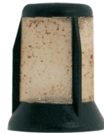
Pré-filtro da E3T – entupido devido a oxidação
