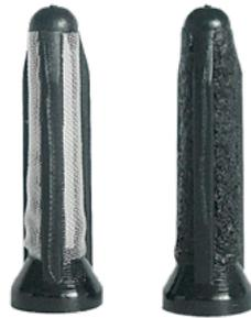
Pré-filtro da E1F: novo à esquerda, entupido à direita
