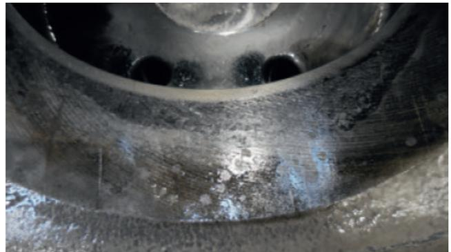
Détériorations de la surface par microfriction sur une boîte de vitesses
