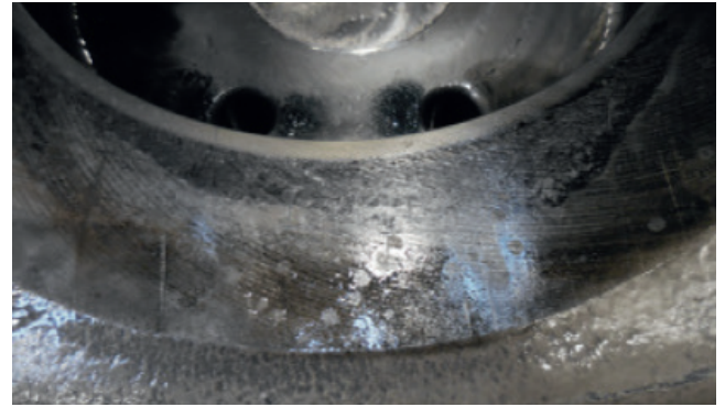
Bir şanzımda mikro sürtünme nedeniyle yüzey hasarları
