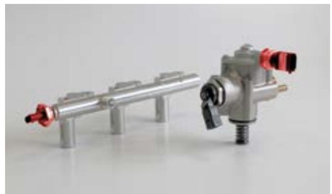
Kraftstoffdrucksensoren (hervorgehoben) am Kraftstoffverteilerrohr und an der Hochdruckpumpe
