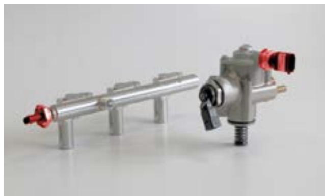
Capteurs de pression de carburant (mis en évidence) sur le tube de distribution de carburant et la pompe à haute pression
