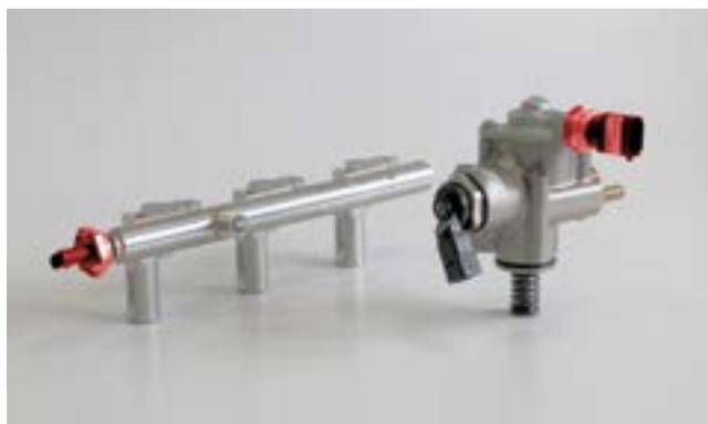
Sensores de pressão do combustível (destacados) no distribuidor de combustível e na bomba de alta pressão
