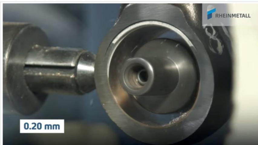
Webserie Módulo 10: Instalación y mecanizado de buje de biela semi acabado
