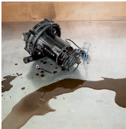
Rys. 28 Kondensat w pompie powietrza wtórnego
