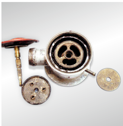
Rys. 30 Odlączalny zawór zwrotny – uszkodzenia membrany oraz talerza zaworu przez kondensat
