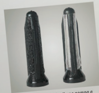
Fig. 22: Filtro a reticella di una pompa a palette E1; A sinistra otturato - a destra nuovo
