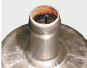
Raccordo di entrata della pompa arrugginito (danno da acqua)
