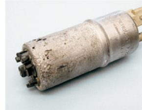
Corrosione da contatto
