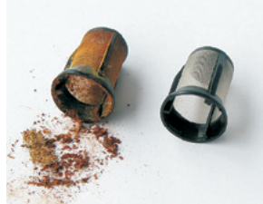
Filtro a reticella ostruito e stato a nuovo
