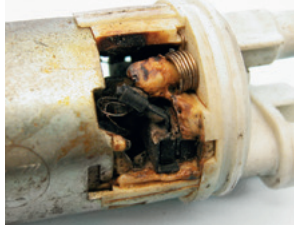
Danni da fusione in seguito a funzionamento a secco
