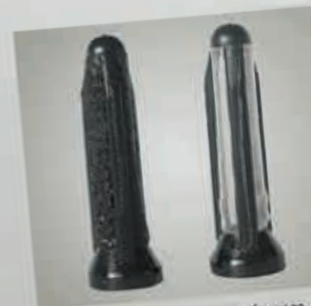
Рис. 22: Сетчатый фильтр виброчного пластичного насоса E1F слева забит — справа новый
