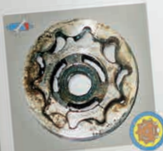
Рис. 19: Блокированный насос (треугольное шестерёчатое колесо) шестерёчатого насоса E37
