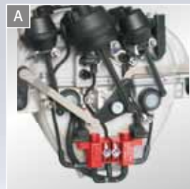
A 活梅赛德斯 C 系进气管上的电动转换阀 (EUV) (颜色加亮区域)。
