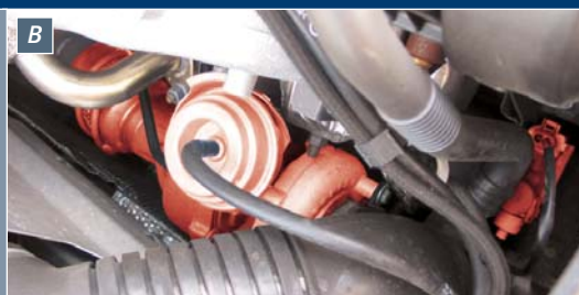
B Elektropneumatische druk-converter (EPW) en turbocompressor in een Audi A4 TDI (rood).
