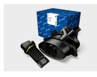
Как вставные сенсоры или с проточной трубой: сенсоры воздушных масс Pierburg измеряют с максимальной точностью.
