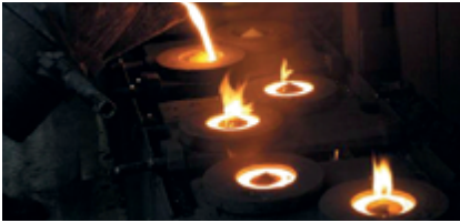
Ham piston segmanlarının dökülmesi (kokil döküm)
