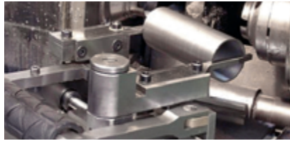
Piston segmanı çalışma yüzeyinin taşlanması
