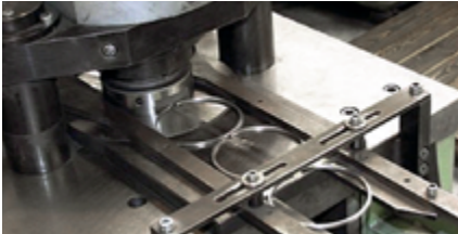
İçten tornalama makinesi – İç kontürün üretimi
