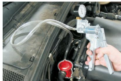
Mit einfachen Werkzeugen lassen sich pneumatische Bauteile leicht prüfen.
