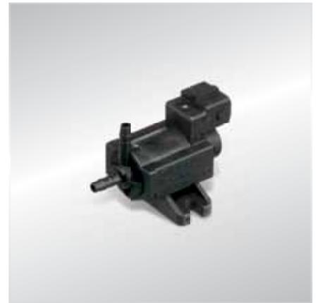
As válvulas de comutação elétricas (EUV) funcionam como interruptores para componentes de comando a vácuo. Estas permitem apenas abrir ou fechar as válvulas pneumáticas de ar secundário. A mais recente geração de válvulas de ar secundário não precisa do comando por uma EUV.
