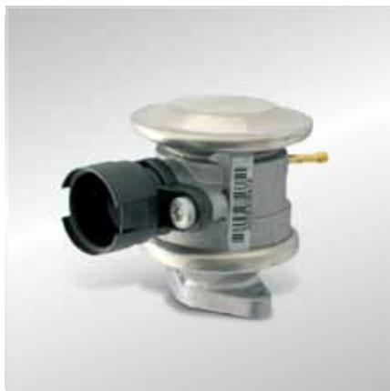
A válvula de retenção que pode ser desligada assegura que o ar secundário só entra no colector de escape fase de arranque a frio. Uma válvula de retenção integrada evita que os gases de escape, a água de condensação ou os picos de pressão no sistema de gases de escape (p. ex., falhas de ignição) causem danos na bomba de ar secundário.
