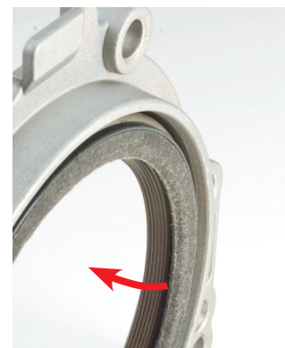
Figure 2 _La lèvres d'étanchéité est orientée vers l'intérieur du moteur
