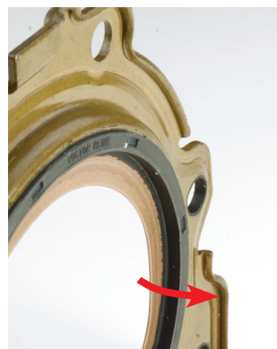
Figure 1 _La lèvres d'étanchéité est orientée vers la boîte de vitesses
