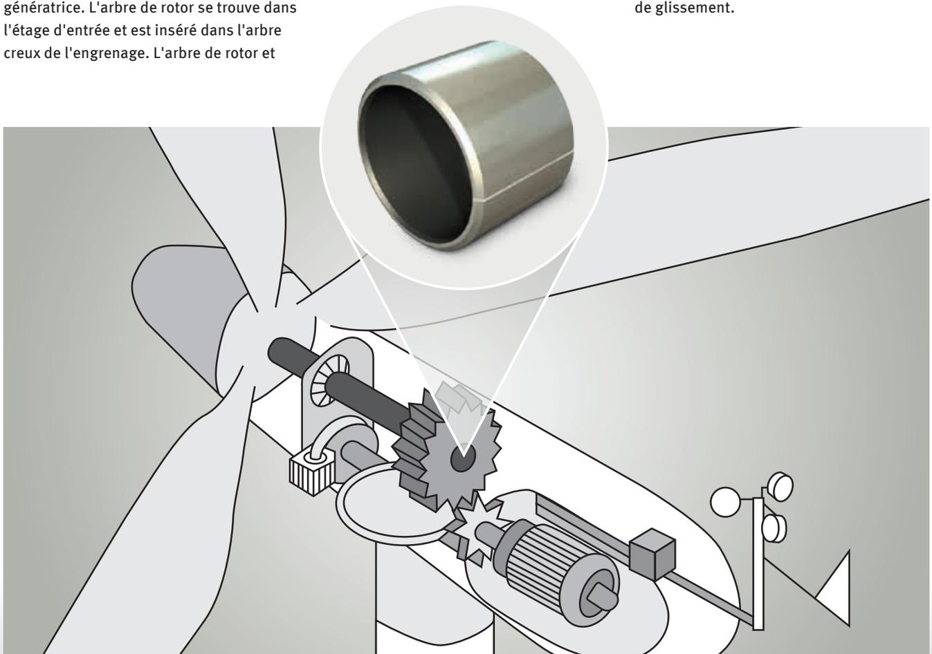
Les coussinets KS PERMAGLIDE® P10 sont mis en œuvre comme paliers de guidage de l'arbre de rotor dans l'engrenage de centrales éoliennes
