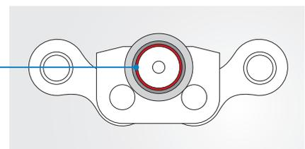
Lagerungen in Mitnehmerketten von Hochregalhubwagen mit Permaglide® Gleitlagerbuchse Bauart PAP ... P200
