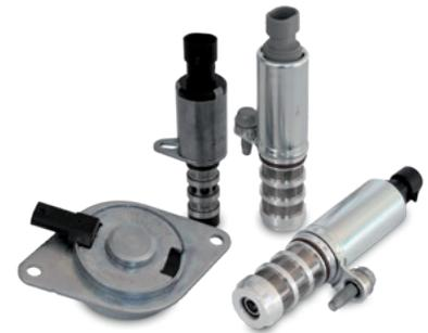
Die Steuerventile sind ein wesentlicher Bestandteil der Nockenwellenverstellung moderner Motoren. Abhängig von der Motordrehzahl leiten die Steuerventile den Ölfluss durch unterschiedliche Ölkanäle zu den jeweiligen Kammern im hydraulischen Nockenwellenversteller. Dadurch wird die Nockenwelle relativ zum Nockenwellenrad verdreht und die Steuerzeiten, also die Öffnungs- und Schließzeitpunkte der Ein- und Auslassventile, verändert.
